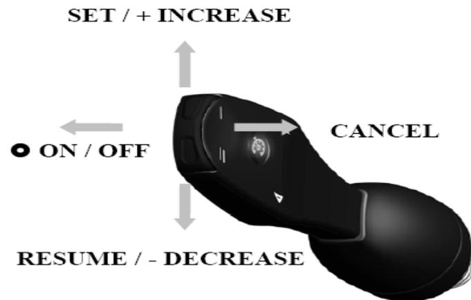
A) Mettre le produit sous tension position **ON** en poussant 1 seconde le commodo vers l'arrière, la led située sur le commodo devient VERTE fixe.
