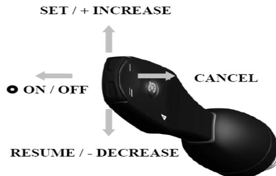
A) En roulant mettre le produit sous tension position **ON** en poussant le commodo vers l'arrière pendant 3 secondes, la led située sur le commodo devient VERTE fixe et le limiteur confirme par 3 bips..
